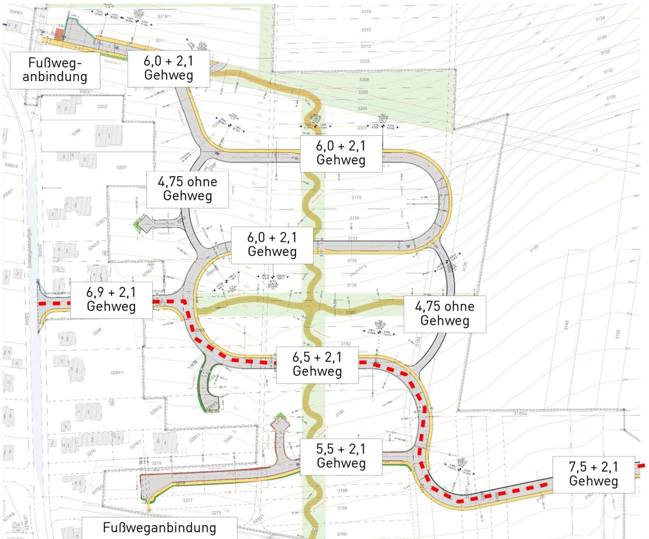
Abb. 6-5: Verkehrliche Erschließung, Gfrörer Ingenieure (2022)
