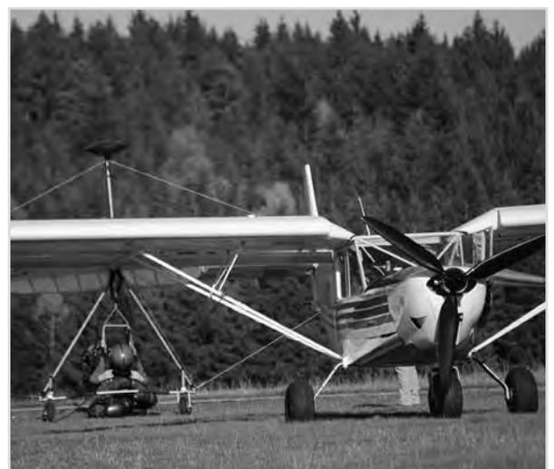
Hängegleiterschlepp mit dem Ultraleichtflugzeug
