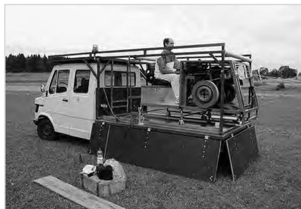
Doppeltrommelwinde auf Lkw
